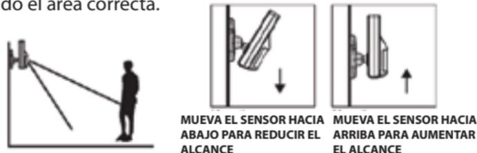
La distancia a la cual el sensor puede detectar movimiento puede ser ajustada al alterar el ángulo del sensor. Para reducir el ángulo de detección, simplemente mueva el sensor hacia abajo y mueva el sensor hacia arriba para maximizar el rango.
